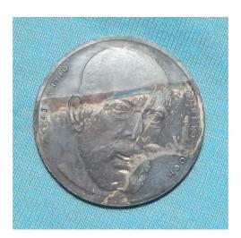
Die Münze wurde dann in ein Patinierungsbad eingebracht, die Metalloberfläche wurde an den freigelegten Teilen (sichtbar und unsichtbar) mit Silbersulfid überzogen. Das entspricht in etwa der Bildung natürlicher Silberpatina.
