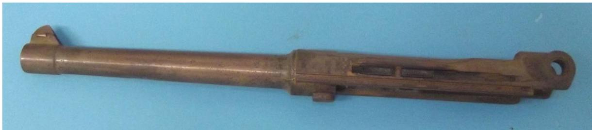
Mit einer weichen, feinen (0,05 mm) Drahtbürste bearbeitet man die Oberfläche jetzt gründlich, dabei werden alle losen Teile entfernt.
