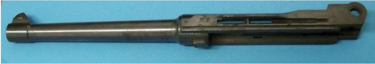
Die Oberfläche ist jetzt bereits deutlich dunkler, gleichmäßiger und widerstandsfähiger.
