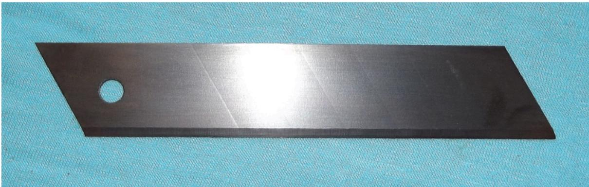
Die entstehende Färbung ist dunkelbraun bis hin zum schwarz. Um schwarz zu erzielen, kann das brünierte Werkstück für ca. 30 Minuten in kochendem Wasser oder alternativ in Wasserdampf behandelt werden. Durch die Dampfbehandlung vertieft sich die dunkle Färbung. Danach dann gut trocknen, indem das Werkteil mind. 2 Tage an einem warmen, trockenen Ort gelagert wird.
